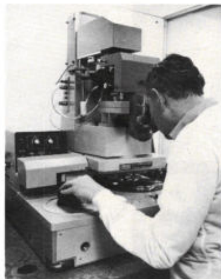
Afb. 2. Met de waferstepper kan men een maskerpatroon herhaald op een wafer projecteren.
