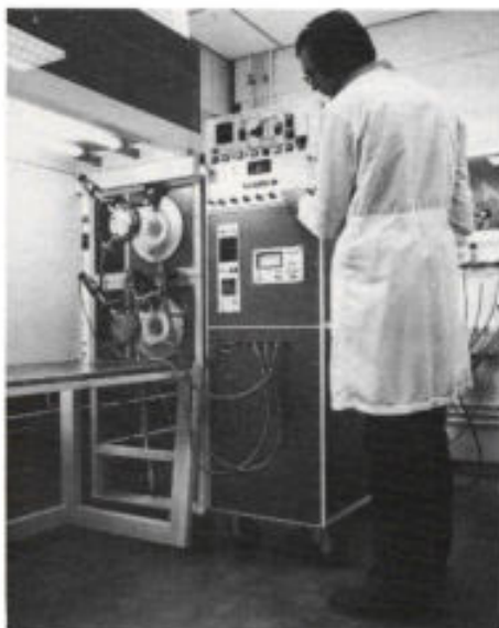
Afb. 1. Twee reactoren voor Low Pressure Chemical Vapour Deposition.
